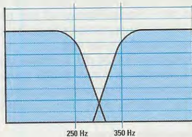
Fig.2 Se il filtro Passa/Basso taglia su una frequenza più bassa di quella del Passa/Alto avremo una "attenuazione" di tutte le frequenze presenti in questo "buco".
