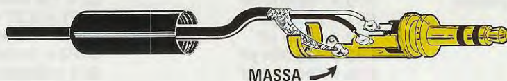
Fig.8 Nello spinotto Jack, che inserirete nella presa "cuffia TV", dovrete saldare la calza di schermo sul terminale di massa e gli altri due fili sui 2 terminali più corti.
